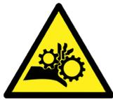
Das Risiko liegt dann vor, wenn die Finger während der Bewegung des Getriebes und der Kette in den Öffnungsschlitz eingeführt werden.
